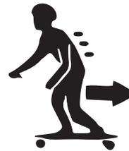
Drücken Sie den Gashebel nach hinten, um das Board abzubremsen. Bewegen Sie den Gashebel in kleinen Schritten. Halten Sie eine gerade Haltung auf dem Brett. Halten Sie einen niedrigen Schwerpunkt. Lehnen Sie sich nach hinten beim Bremsen.
