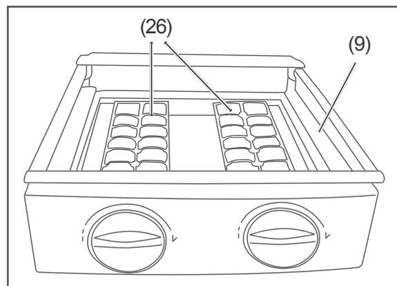
2. Füllen Sie die Eisschalen (26) bis zur Markierung WATER LEVEL mit frischem Trinkwasser.
