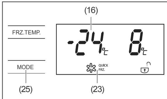
Wählen Sie die Einstellung (23) QUICKFRZ. „Schnelles Einfrieren“, um den Gefrierbereich vor dem Einlagern von Lebensmitteln vorzukühlen und zum Einfrieren frischer Lebensmittel.
