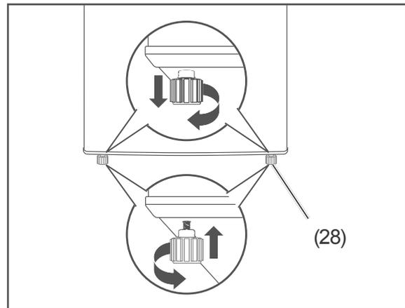
4. Gleichen Sie Unebenheiten des Untergrunds mithilfe der beiden vorderen Schraubfüße (28) aus.
