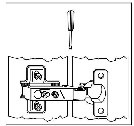
T11 Bei Türmontage das Scharnier einhängen, bis Anschlag öffnen und anschließend festschrauben.
