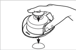
Durch gleichmäßigen Druck auf den Stempel wird das Schneidgut automatisch nachgeschoben. Ein evtl. Rest kann durch Druck auf den Stempel einfach ausgeworfen werden.
