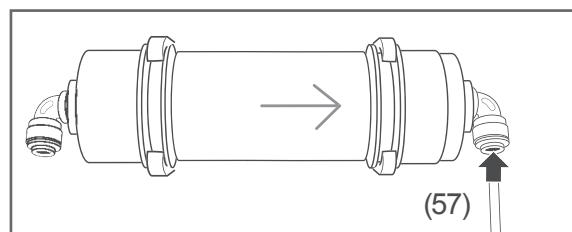
3. Stecken Sie das Ende des Geräteschlauchs bis zum Anschlag in die Schlauchkupplung, zu der der Pfeil am Wasserfilter zeigt.
