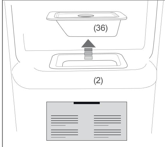
1. Entfernen Sie die Verschlussbox (36) aus dem Eisspender (2). Bewahren Sie die Verschlussbox gut auf, für den Fall, dass Sie den Eisbereiter sperren möchten.
