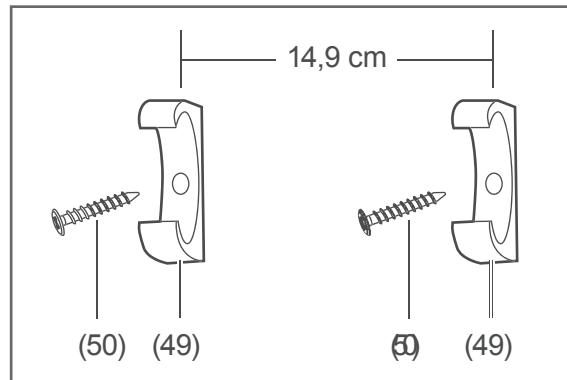
6. Schrauben Sie die Wandhalterungen (49) mit den Schrauben (50) an der Wand fest. Verwenden Sie dazu einen Kreuzschlitz-Schraubendreher. Die Schrauben versinken dabei in den Wandhalterungen.
