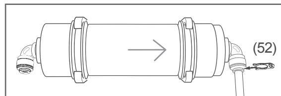
4. Fixieren Sie den Geräteschlauch mithilfe eines Sicherheitsclips (52).
