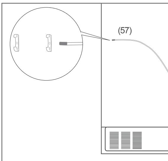
1. Bestimmen Sie die Montagehöhe des Wasserfilters (44). Der weiße Geräteschlauch (57) muss bis zum Wasserfilter reichen. Sollte der weiße Geräteschlauch zu kurz sein, verlängern Sie ihn mithilfe des blauen Verlängerungsschlauchs (58) (siehe „Geräteschlauch verlängern“ auf Seite DE-40).
