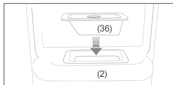
3. Verschließen Sie den Eisspender (2) mit der Verschlussbox (36), um Energie zu sparen.
