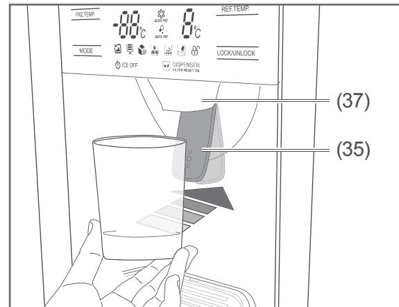
2. Halten Sie das Gefäß so dicht wie möglich an die Öffnung des Eisauslasses (37), um ein seitliches Danebenspritzen zu verhindern.
