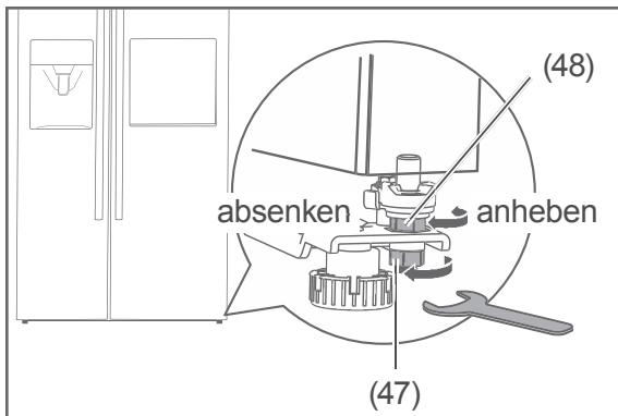
2. Drehen Sie die Sicherungsmutter (a) zwei volle Umdrehungen im Uhrzeigersinn, um sie zu lösen. Verwenden Sie dazu den mitgelieferten Schraubenschlüssel.
