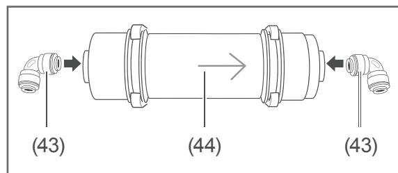
1. Stecken Sie die Schlauchkupplungen (43) auf den Wasserfilter (44) und drücken Sie sie fest.
