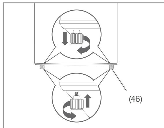
2. Gleichen Sie Unebenheiten des Untergrunds mithilfe der beiden vorderen Schraubfüße (46) aus.
