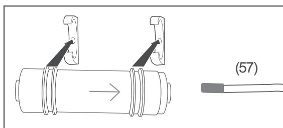
8. Drücken Sie den Wasserfilter so in die Wandhalterungen, dass der Pfeil auf dem Wasserfilter in Richtung des weißen Geräteschlauchs (57) zeigt.
