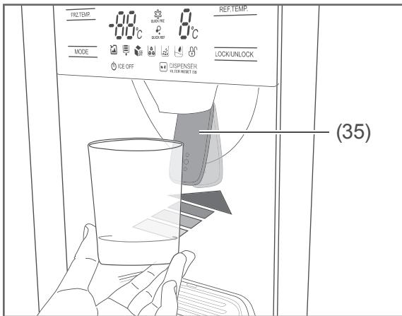
2. Drücken Sie das Gefäß gegen das Entnahmepad (35). Gekühltes Wasser beginnt in das Gefäß zu fließen.
