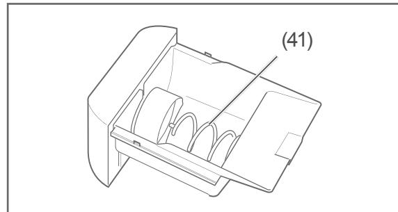
1. Entsorgen Sie eventuell vorhandene Eiswürfel im Abfluss. Bewegen Sie ggf. die Transportschnecke (41) im oder gegen den Uhrzeigersinn, um verkantete Eiswürfel zu lösen.
