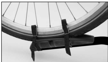
Figura 16: Cinghie di fissaggio ruota anteriore
