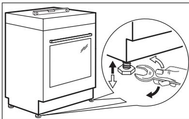
Richten Sie das Gerät mit den unten angebrachten Schraubfüßen so aus, dass
