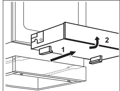
2. Heben Sie die Schublade leicht an und ziehen Sie sie aus den Führungen.
