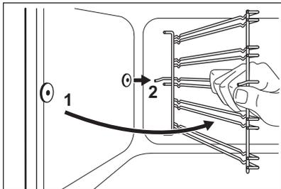
Führen Sie zum Einsetzen der Einhängegitter die oben aufgeführten Schritte in umgekehrter Reihenfolge durch.
