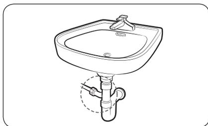
2. Schließen Sie den Schlauchanschluss direkt an das Abflussrohr des Waschbeckens an.
