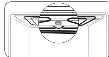
1. Sie können das Heizelement für den Grill absenken. Das ist hilfreich bei der Reinigung der Ofendecke. Entfernen Sie die Mutter. Drehen Sie sie zu diesem Zweck im Uhrzeigersinn, und halten Sie dabei das Heizelement fest.
