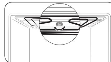
3. Heben Sie das Heizelement nach der Reinigung wieder zurück in seine ursprüngliche Stellung, und ziehen die Mutter im Uhrzeigersinn fest.
