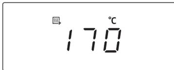
Das Gerät zeigt das Symbol und heizt vor, bis der Garraum die eingestellte Zieltemperatur erreicht. Es wird empfohlen, den Garraum unabhängig von der Betriebsart stets vorzuheizen, sofern in den Zubereitungshinweisen nicht abweichend angegeben.
