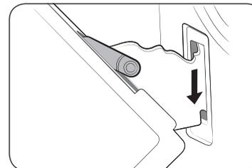
3. Um die Gerätetür nach der Reinigung wieder zu befestigen, wiederholen Sie die Schritte 1 und 2 in umgekehrter Reihenfolge. Der Clip am Scharnier sollte auf beiden Seiten geschlossen sein.
