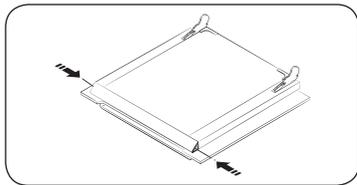
1. Drücken Sie auf die beiden Riegel links und rechts der Gerätetür.
