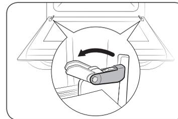
1. Öffnen Sie die Gerätetür, und klappen Sie die Clips an den beiden Scharnieren auf.
