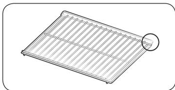
Schieben Sie den Rost so in das Gerät, dass die nach oben gebogene Seite nach hinten weist, damit bei der Zubereitung großer Mengen der verfügbare Platz voll ausgenutzt werden kann. (Je nach Modell)
