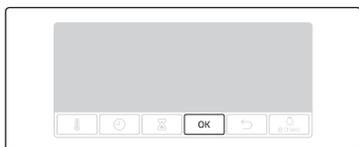
3. Drücken Sie auf **OK**, um den Reinigungsvorgang zu starten. Die Dampfreinigung dauert 26 Minuten.
