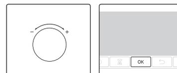
2. Wählen Sie mit Hilfe des Funktionswählers ein Programm aus, und drücken Sie auf **OK**. Im Display wird der verfügbare Gewichtsbereich (Portionsgröße) angezeigt.
