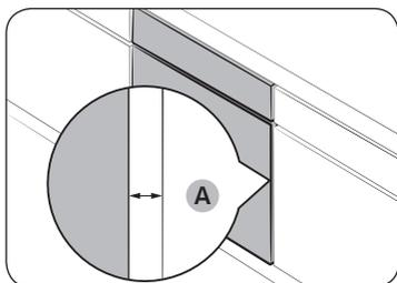
Halten Sie zu beiden Seiten des Geräts einen Abstand **(A)** von mindestens 5 mm zu den Seitenwänden des Schrankes ein.
