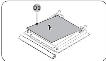
2. 2 Lösen Sie die Abdeckung, und entnehmen Sie Scheibe 1 aus der Gerätetür.
