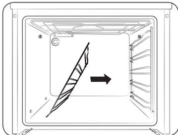
3. Ziehen Sie das Seitengitter aus den beiden unteren Bohrungen heraus.
