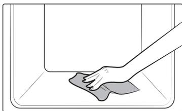
4. Reinigen Sie den Garraum mit einem feuchten Tuch.
