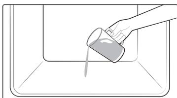
1. Gießen Sie ca. 400 ml Wasser auf den Boden des Garraums, und schließen Sie die Gerätetür.
