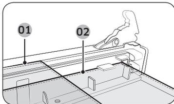
3. Wiederholen Sie die Schritte 1 und 2 in umgekehrter Reihenfolge, um die Scheiben nach dem Reinigen wieder in die Gerätetür einzusetzen. Überprüfen Sie anhand der Abbildung die richtigen Positionen der Scheiben 1 und 2.
