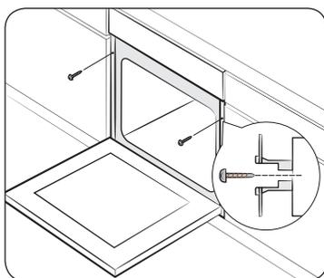
Schieben Sie das Gerät in den Schrank, und befestigen Sie es zu beiden Seiten mit Hilfe von 2 Schrauben.
