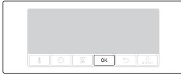
3. Drücken Sie auf **OK**. Das Gerät setzt den Garvorgang mit der zuvor eingestellten Temperatur, jedoch ohne vorgegebene Garzeit fort.
