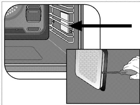
3. Lösen Sie das Schutzglas mit einem Schraubendreher.
