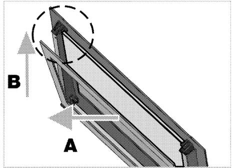
Der erste Schritt zum Zusammensetzen der Tür besteht darin, die Innenscheibe (2) wieder anzubringen. Platzieren Sie die abgeschrägte Ecke der Scheibe wie in der Abbildung gezeigt so, dass sie in der abgeschrägten Ecke des Kunststoffschlitzes aufliegt.
