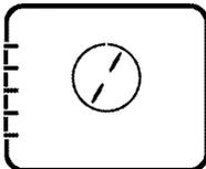
Durch den Lüfter wird heiße Luft vom Umluft-gestützten Heizelement mit hoher Geschwindigkeit im Backofen verteilt. Diese Betriebsart eignet sich zum Garen auf unterschiedlichen Einschubebenen; in den meisten Fällen ist kein Vorheizen erforderlich. Mehrere Bleche können verwendet werden.
