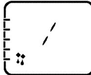
Der Backofen wird nicht beheizt. Nur der Lüfter (in der Rückwand) arbeitet. Gefrorene Lebensmittel werden langsam bei Zimmertemperatur aufgetaut, heiße Lebensmittel abgekühlt.
