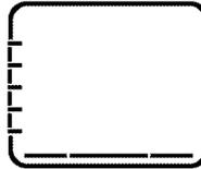
Bei dieser Betriebsart wird lediglich das untere Heizelement eingesetzt. Geeignet z. B. für Pizza und zum Nachbräunen von unten.
