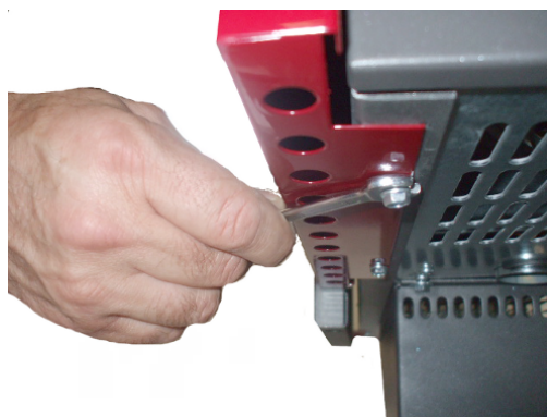
Fig. 30 - Befestigung der Platten
