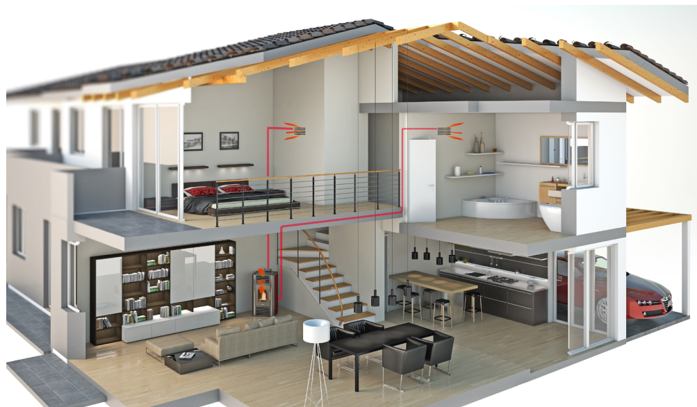
Fig. 45 - Beispiel einer Kanalisierung
