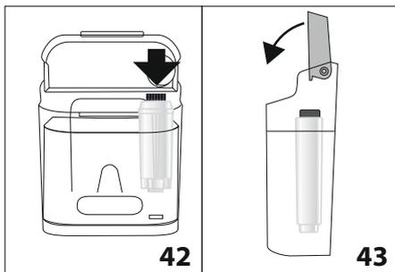
Wenn der Filter eingesetzt wird, muss sein Vorhandensein dem Gerät mitgeteilt werden.
