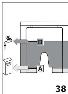
7. Füllen Sie den Entkalker in den Wassertank, bis der auf der Rückseite aufgedruckte Füllstand A erreicht ist (entspricht einer 100ml-Packung) (Abb. 38); geben Sie dann bis zum Füllstand B (Abb. 38) Wasser dazu (ein Liter) und setzen Sie den Wassertank wieder ein.
