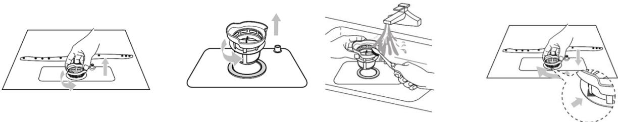
1. Grobfilter (2) gegen den Uhrzeigersinn drehen und die Filter nach oben anheben.
