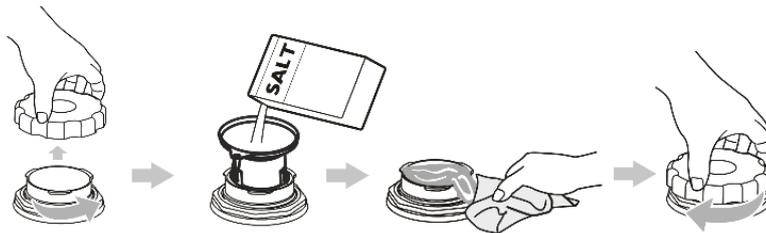
1. Unterkorb entfernen, Deckel des Salzbehälters abschrauben.
