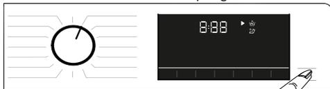
Falls der Wasserstand in der Maschine bei Betätigung der Taste **Start/Pause** zu hoch ist, kann die Türsperre nicht deaktiviert werden und das Türverriegelungssymbol im Display bleibt eingeschaltet.
