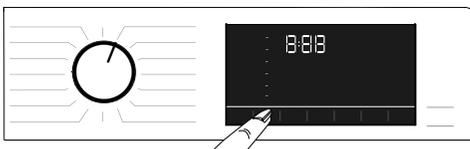
Nachdem ein Programm ausgewählt wurde, wird die empfohlene Schleuderdrehzahl des gewählten Programms in der Anzeige **Schleuderdrehzahl** angezeigt.
