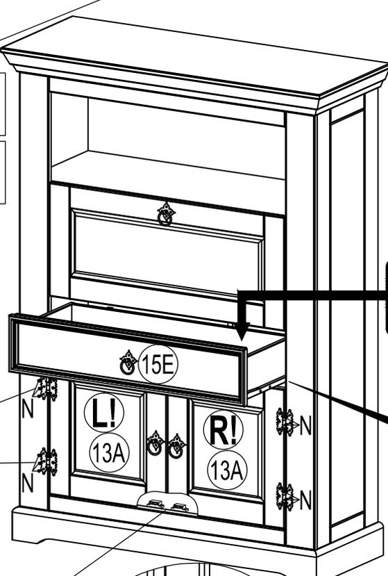
"Die Schubkastenschiene kann bei Bedarf durch Lösen und Fixieren der Schraube am Langloch eingestellt und nachjustiert werden"
