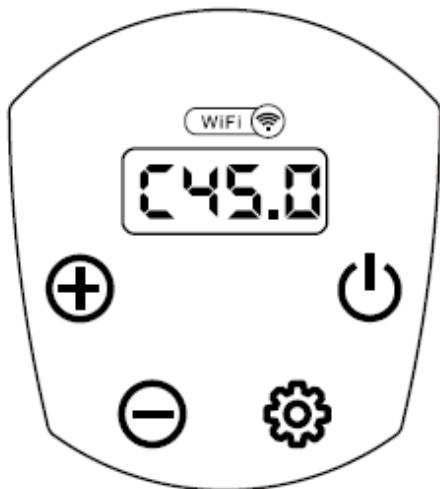
Display: Die aktuelle Temperatur und die verbleibenden Garzeit werden in 5-Sekunden-Schritten angezeigt
