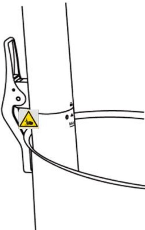
Fixez l'appareil en le bloquant sur le réceptacle.
