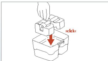
**Setzen Sie den Nasssaug-Einsatz von oben in den Schmutzwasserbehälter ein.**
