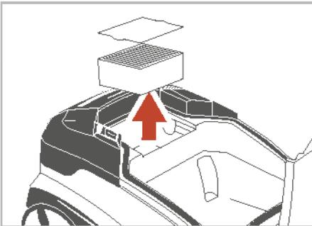
Spezial-Hygiene-FILTER und Vorfilter reinigen
