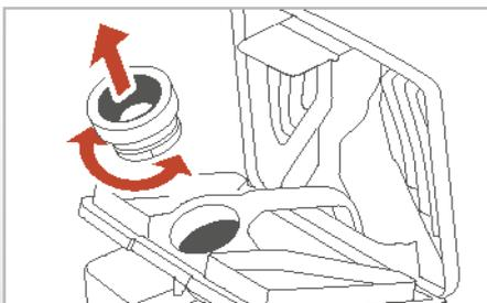
Bei starker Verschmutzung kann der sogenannte Ejektor durch Drehen der Stützendichtung für die Reinigung entnommen werden. Spülen Sie den Ejektor mit warmem Wasser ab.
