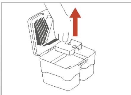
Sofern sich noch Schmutz im Schmutzwasserbehälter der AQUA-Pure-Filterbox befindet, reinigen Sie diesen gründlich unter fließendem Wasser und gießen das Schmutzwasser über die Ausgießöffnung aus. Bei starker Verschmutzung des Ansaugfilters entnehmen Sie diesen aus dem Schmutzwasserbehälter und reinigen ihn unter fließendem Wasser.
