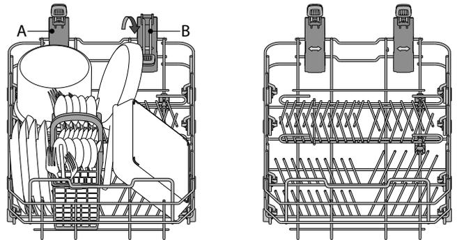
Der Unterkorb verfügt über klappbare Ablagen, die in vertikaler Stellung für Teller oder in horizontaler (niedriger) Position für Pfannen und Salatschüsseln verwendet werden können.
