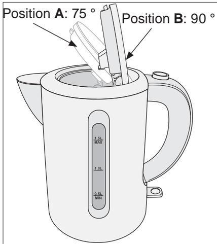
**HINWEIS:** Wir empfehlen, zum Reinigen des Wasserkochers oder des Siebes sowie zum Entleeren nach dem Entkälten den Deckel in Position B (90 °) zu öffnen.
