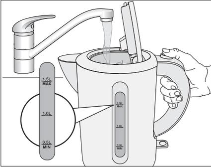
3. Füllen Sie den Wasserbehälter mit frischem, kaltem Leitungswasser (min. 0,5 bis max. 1,5 Liter; bei der Erstinbetriebnahme 1,5 l).
