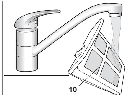
2. Sieb **10** unter laufendem Wasser reinigen.
