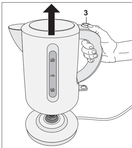
2. Drücken Sie, auf den Deckelöffner **3**, um den Deckel zu öffnen.
