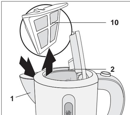
1. Im Ausguss **1** befindet sich ein Sieb **10**. Sieb bei geöffnetem Deckel **2** entnehmen.
