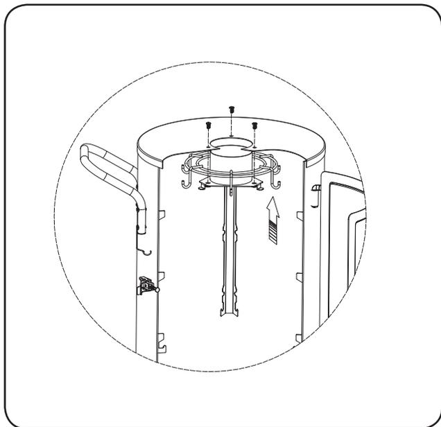
7. Befestigen Sie das Ventil und Bedienfeld (13) mit Schrauben (BB) an der Räucherkammer. Stecken Sie das Zündkabel in das Ventil.
