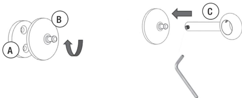
1. Montageplatte (A) mit Dübel und Schrauben an der Wand befestigen
