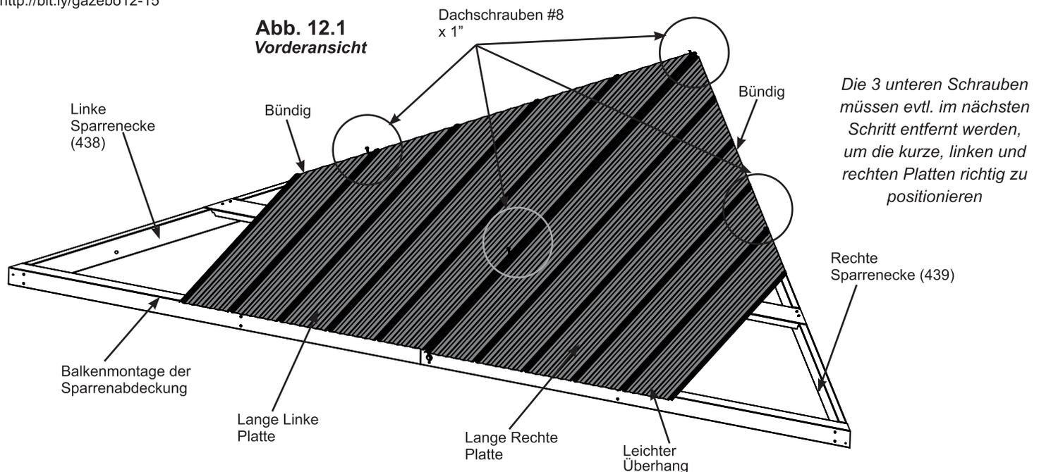
*Die 3 unteren Schrauben müssen evtl. im nächsten Schritt entfernt werden, um die kurze, linken und rechten Platten richtig zu positionieren*
