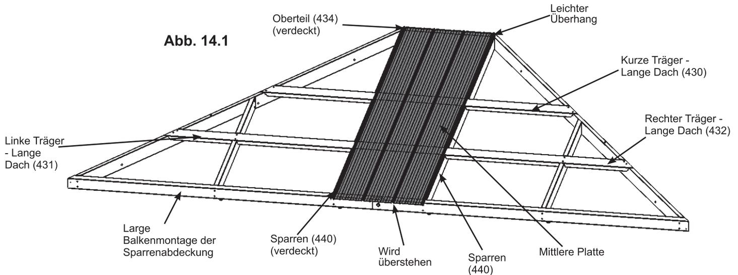
**Die Schrauben NICHT ZU FEST ANZIEHEN, da das Dachmaterial beschädigt werden könnte**
