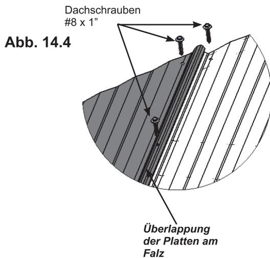
**Die Schrauben NICHT ZU FEST ANZIEHEN, da das Dachmaterial beschädigt werden könnte**
