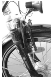
Federgabel mit Elastomer/ Federdämpfung
