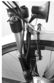
Einstellbare Federgabel mit Lock-Out (Sperre) und Justiermöglichkeit
