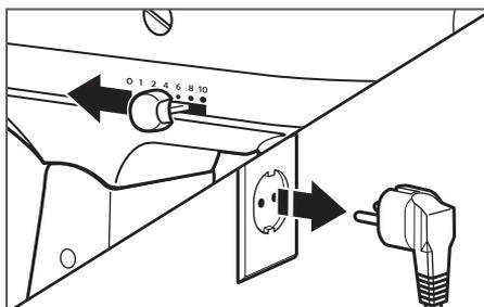
**1** **So bringen Sie ein Werkzeug an:** Die Geschwindigkeitssteuerung auf „0“ setzen. Ziehen Sie den Netzstecker der Küchenmaschine.
