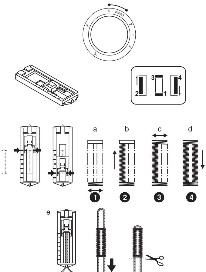
Befolgen Sie die Schritte 1-4 mit verschiedenen Einstellungen des Stichwählrads. Achten Sie bei den verschiedenen Schritten darauf, dass die Nadel angehoben wird, bevor Sie das Stichwählrad neu einstellen. Nähen Sie bei den Schritten 1 und 3 nicht zu viele Stiche. Öffnen Sie das Knopfloch mit einem Nahttrenner von beiden Seiten zur Mitte hin.
