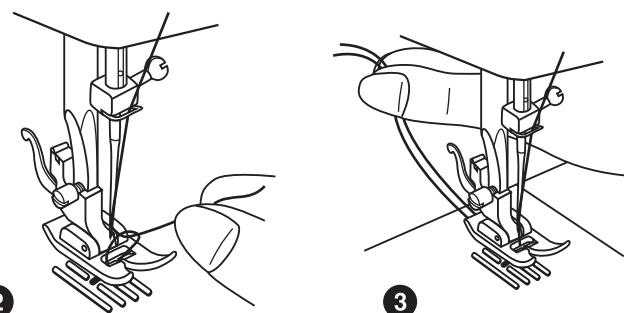
Den Oberfaden behutsam ziehen, um den Unterfaden durch die Öffnung der Stichplatte nach oben zu bringen. (2)
