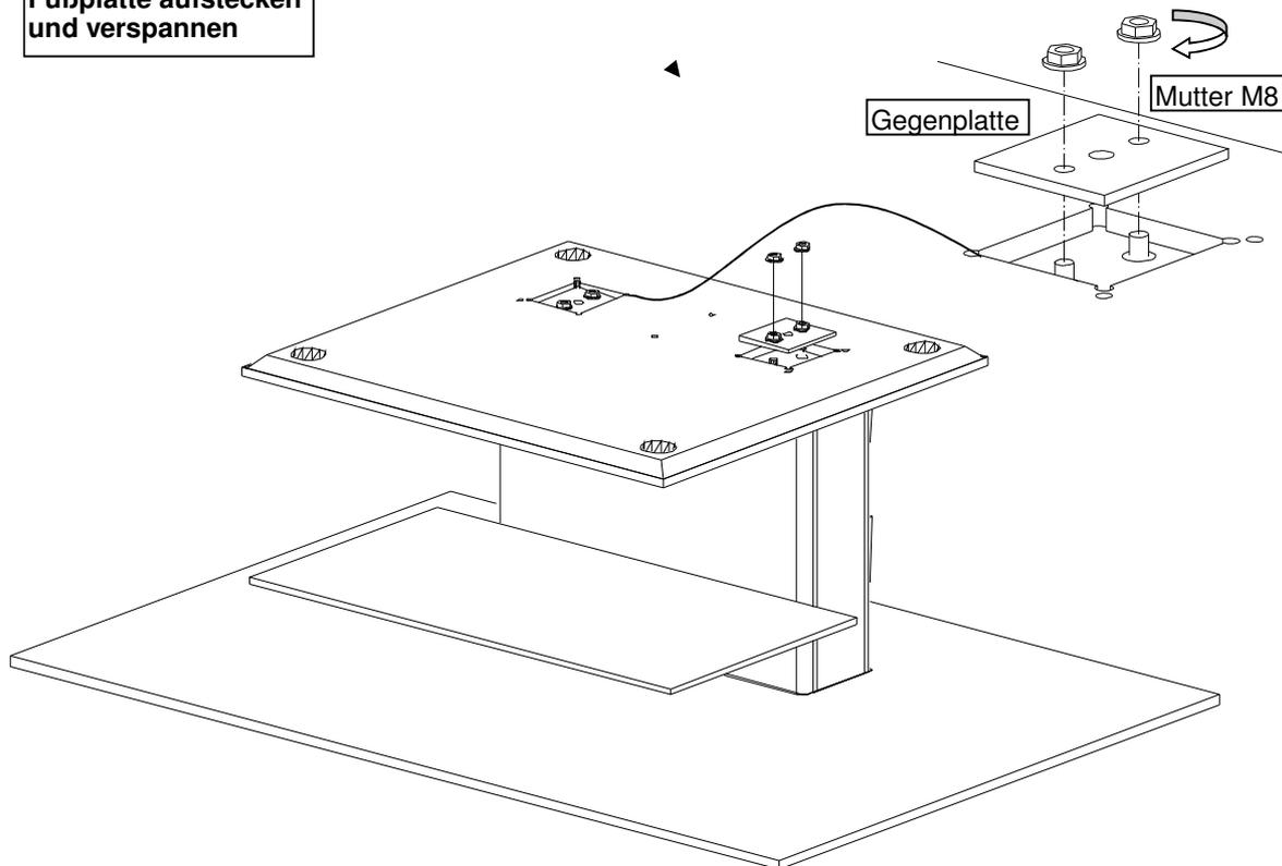
**Fußplatte mit Säule verschrauben**
