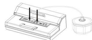
Retire el tubo flexible de vacío de la conexión de la tapa del recipiente y del aparato.
