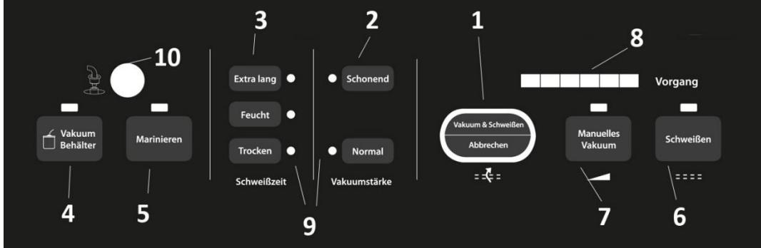
**1 Sotto vuoto e saldatura/Interruzione (Vakuum&Schweißen/Abbrechen):** Questo pulsante ha due funzioni dipendenti dallo stato dell'apparecchio
