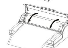
Überprüfen Sie, dass der Cutter an einem Ende der Cutterschiene positioniert ist. Drücken Sie dann die Cutterschiene wieder nach hinten.
