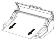
Asegúrese de que el dispositivo de corte esté colocado a un extremo de su carril. A continuación, vuelva a presionar el carril del dispositivo de corte hacia atrás.
