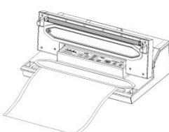
Mettez une extrémité du sachet sur le joint en caoutchouc, mais pas dans la chambre à vide.
