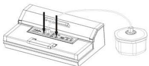
Pressez „Vakuumbehälter“ (récipients). Pressez fermement au début le couvercle pour éviter que de l'air s'échappe. Le procédé sous vide s'arrête automatiquement, si l'intensité suffisante sera atteinte.
