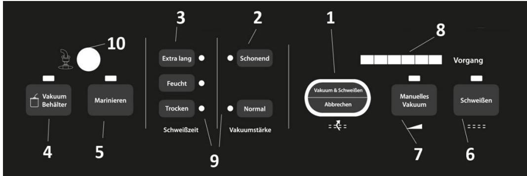
**1 Vacío y sellado/Interrumpir (Vakuum&Schweißen/Abbrechen):** Este botón tiene dos funciones, dependiendo del estado del aparato.
