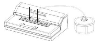
Verwijder de vacuümslang van de aansluiting aan het deksel van de bak en aan het apparaat.
