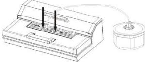
Pulse "marinar" (Marinieren). La indicación de progreso LED se ilumina durante el proceso. El aire se extrae y vuelve a entrar automáticamente tras el proceso de vacío. Tras tres minutos de pausa comienza el ciclo de trabajo desde el principio. El proceso pasa por 5 ciclos de trabajo.
