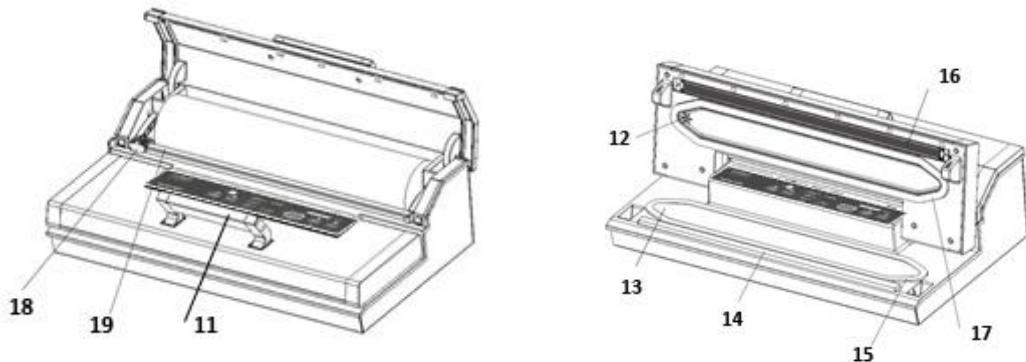
**11 Manico anteriore:** Spingerlo in basso per chiudere la copertura. Sollevarlo per aprire la copertura.
