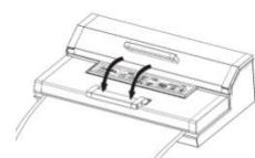
Cierre la tapa y presione firmemente hacia abajo el mango delantero.
