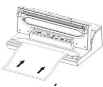
Limpie y alise el extremo abierto de la bolsa y asegúrese de que no hay pliegues ni arrugas en las superficies del extremo abierto.
