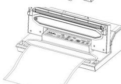
Legen Sie ein Ende des Beutels über die Gummidichtung aber nicht in die Vakuumkammer.
