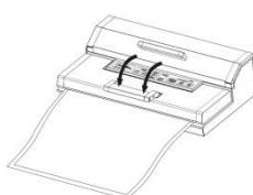
Cierre la tapa y presione firmemente hacia abajo el mango delantero.
