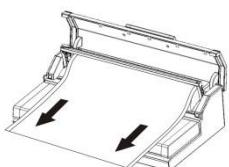
Rollen Sie die Folie auf die von Ihnen gewünschte Länge aus und schneiden Sie sie, mit einem genauen und sauberen Schnitt, auf die gewünschte Länge zu.
