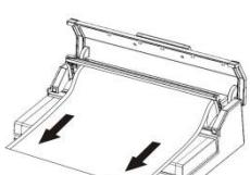
Verificare che il cutter (lama) sia posizionato in una estremità della barra portalama. Premere poi la barra portalama di nuovo indietro.
