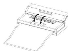
Druk op "Vacuüm & lassen" (Vakuum&Schweißen) De LED-voortgangsindicator licht op en er wordt automatisch lucht afgezogen zodat het zakje wordt afgesloten.
