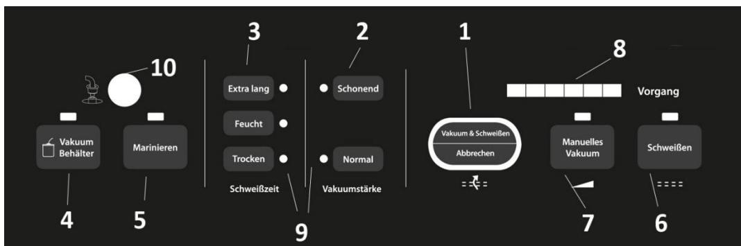
**1 Vacuüm & lassen / afbreken (Vakuum&Schweißen/Abbrechen):** Deze knop heeft twee functies, afhankelijk van de status van het apparaat
