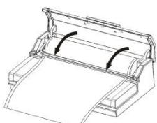
Enrolle la lámina hasta la longitud que desee y córtela hasta la longitud deseada mediante un corte preciso y limpio.
