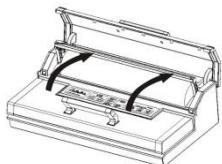
Sluit het apparaat aan het stroomnet aan en plaats de hoofdschakelaar (deze bevindt zich aan de achterkant van het apparaat) op „I“.
