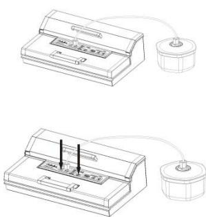
Schließen Sie den Deckel und drücken Sie den vorderen Griff fest herab. Drücken Sie „Marinieren“. Die LED-Fortschritts-Anzeige leuchtet während dem Vorgang. Luft wird entzogen und nach dem Vakuumiervorgang automatisch wieder eingelassen. Nach drei Minuten Pause beginnt der Arbeitszyklus von vorne. Der Vorgang geht über 5 Arbeitszyklen. Wenn die Fortschritts-Anzeige erlischt, ist der Marinievorgang abgeschlossen. Entfernen Sie den Vakumschlauch vom Anschluss am Deckel des Behälters und am Gerät.
