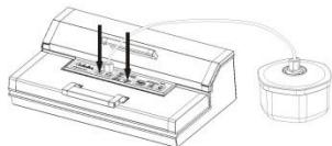
Schließen Sie den Deckel und drücken Sie den vorderen Griff fest herab. Drücken Sie „Vakuumbehälter“. Drücken Sie am Anfang des Vakuumievorgangs den Deckel fest an, um zu verhindern, dass Luft entweichen kann. Der Vakuumievorgang endet automatisch, wenn eine ausreichende Vakuumstärke erreicht ist.
