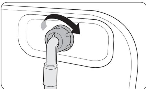
2. Schließen Sie das andere Ende des Frischwasserschlauchs an das Wassereinflussventil auf der Rückseite der Waschmaschine an und drehen Sie den Überwurfring dann nach rechts fest.
