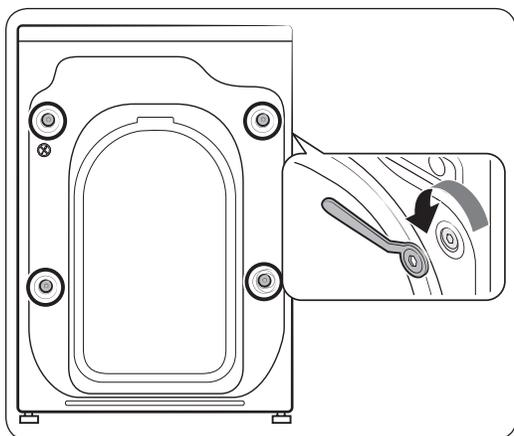
1. Suchen Sie die Transportsicherungen (in der Abbildung mit einem Kreis markiert) auf der Rückseite der Waschmaschine.
