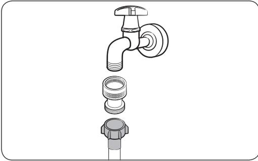
Bevor Sie den Wasserschlauch an einen Wasserhahn anschließen, müssen Sie das mitgelieferte Rückschlagventil an den Wasserhahn anschließen und dürfen erst dann den Wasserschlauch anschließen.
