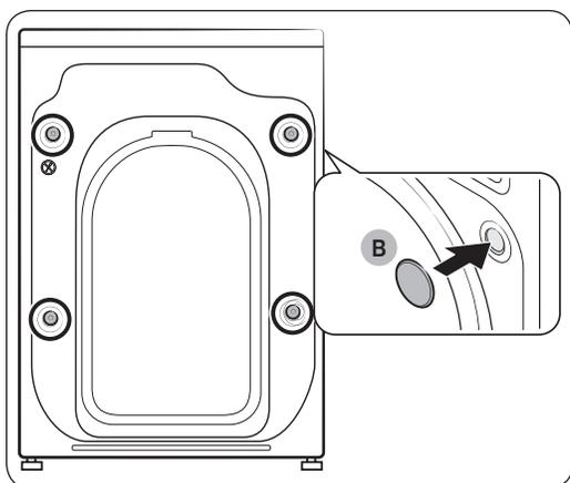
3. Setzen Sie die **Verschlusskappen (B)** in die Öffnungen ein (in der Abbildung mit einem Kreis markiert).
