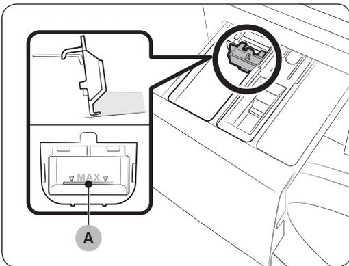
Setzen Sie zunächst den Flüssigwaschmitteleinsatz in das **☞ Hauptwaschmittelfach** ein. Füllen Sie anschließend Flüssigwaschmittel in dem Einsatz. Überschreiten Sie dabei jedoch nicht die **maximale Einfüllhöhe (A)**.
