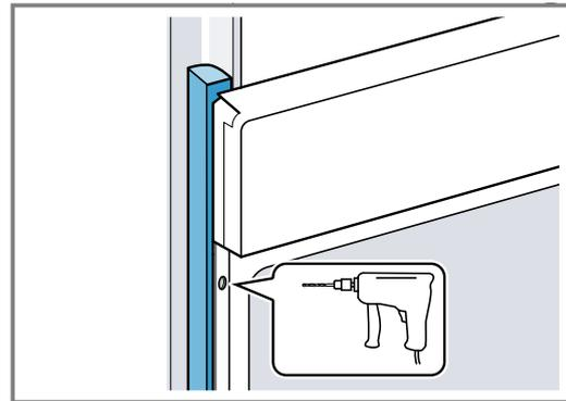
4. Das Gerät mit adäquater Schraube befestigen.
