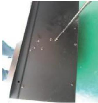
9: Schrauben an beiden Seiten entfernen.
