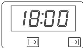
Der Backofen wird sich nun zur errechneten Zeit einschalten und zum eingestellten Abschaltzeitpunkt wieder ausschalten (in der Abbildung oben: 18 Uhr).
