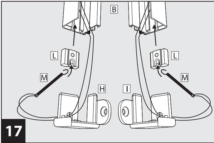
**17** Spannfedern **M** an den Spannleitern **L** einhängen. Spannleiter **L** in die Führungsprofile **B** einsetzen. Endfüße links **H** und rechts **I** wieder auf die Führungsprofile aufstecken.
