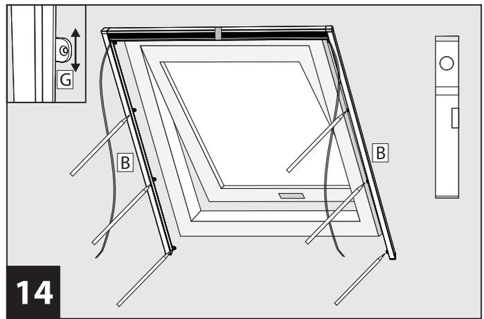
**14** Führungsprofile **B** ausrichten, Wandbefestigungen **G** an die gewünschte Position schieben und Bohrlöcher anzeichnen. Danach die Führungsprofile **B** wieder abnehmen.
