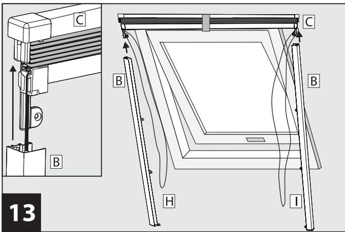
**13** Führungsprofile **B** mit Endfüße links **H** und rechts **I** auf montierte Plisseekassette **C** aufstecken.
