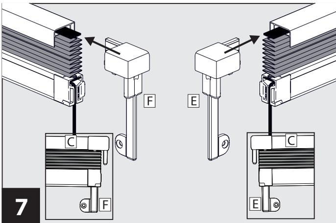
Eckverbinder links **E** und rechts **F** auf die Plisseekassette **C** aufstecken.
