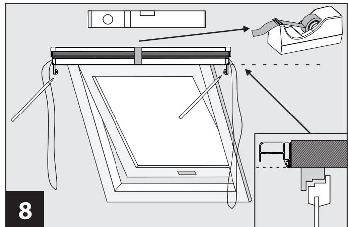
Vormontierte Plisseekassette anhalten. Dabei liegt die hintere, untere Kante der Plisseekassette bündig an der Laibungskante. Mittig und horizontal ausrichten. Bohrlöcher anzeichnen.
