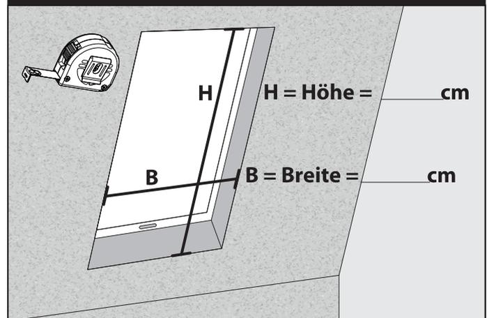
Messen Sie von Dachfenster-Laibung Innenkante zu Innenkante (lichtes Maß) und notieren sich das Ergebnis.
