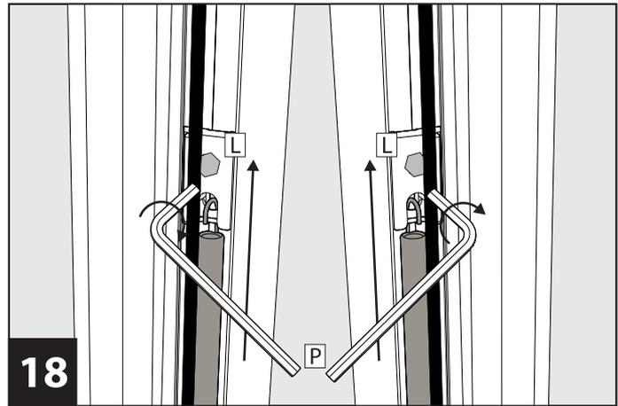
**18** Spannleiter **L** jeweils nach oben schieben um die Plisseeschnüre zu spannen. Spannleiter **L** mit Innensechskantschlüssel **P** fixieren.
