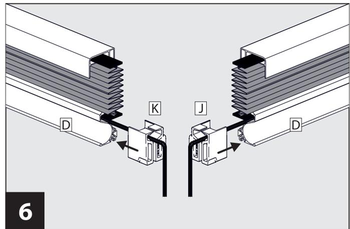
Endkappen Griffleiste links **J** und rechts **K** auf die Griffleiste **D** aufstecken.
