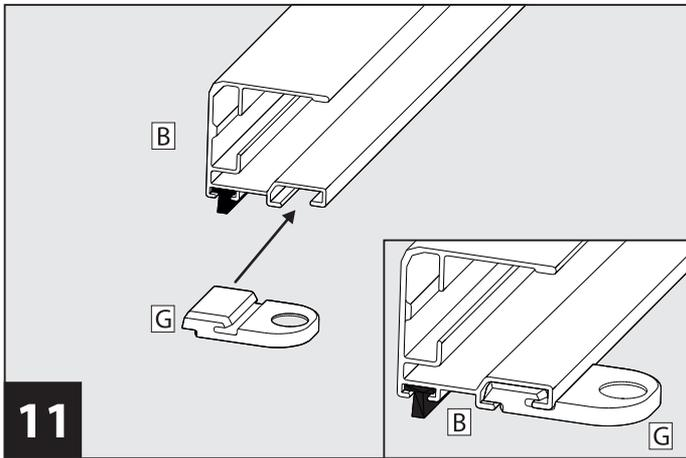
**11** Zwei Stück Wandbefestigungen **G** je Führungsprofil **B** einsetzen.
