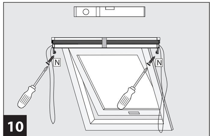
Vormontierte Plisseekassette erneut anhalten und mit Senkkopfschrauben **N** befestigen.
