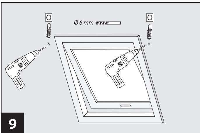
Gekennzeichnete Positionen mit einem  $\varnothing 6$  mm Bohrer vorbohren und Dübel **O** einsetzen.
