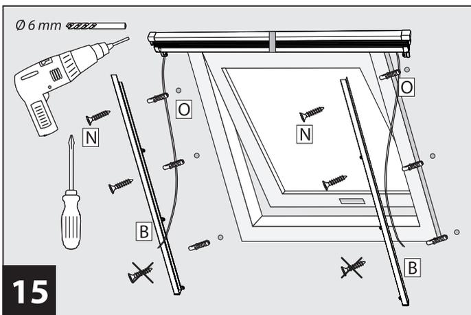
**15** Gekennzeichnete Positionen mit einem  $\varnothing 6$  mm Bohrer vorbohren und Dübel **O** einsetzen. Je nach Untergrund ist ein geeigneter Bohrer zu verwenden (nicht im Lieferumfang enthalten).
