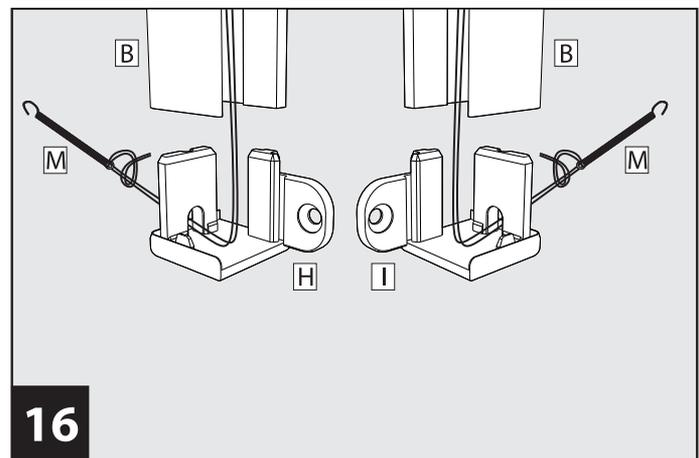
**16** Endfüße links **H** und rechts **I** von den Führungsprofilen **B** wieder abziehen. Plisseeschnüre jeweils von innen nach außen (siehe Bild) durch die Endfüße links **H** und rechts **I** fädeln und an den Enden der Spannfedern **M** verknotten.
