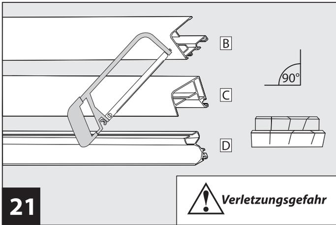
Plisseekassette **C** Griffleiste **D** und Führungsprofile **B** auf Basis der gemessenen lichten Maße kürzen:
