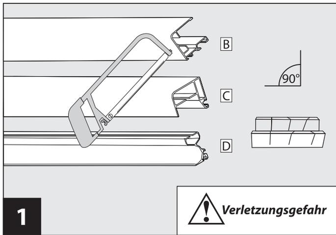
Plisseekassette **C**, Griffleiste **D** und Führungsprofile **B** auf Basis der gemessenen lichten Maße kürzen:
