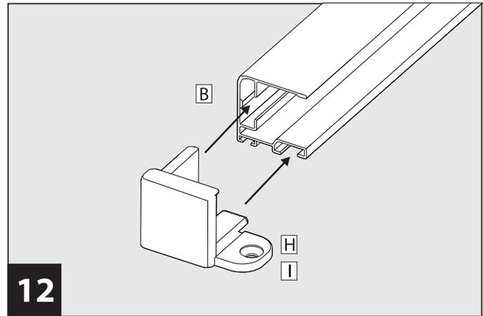
**12** Vorab die beiden Endfüße links **H** und rechts **I** auf die beiden Führungsprofile **B** aufstecken.
