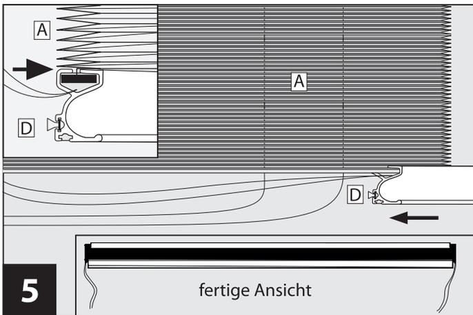
Griffleiste **D** einsetzen. Nehmen Sie zunächst die beiden linken Schnüre und legen Sie diese in die Führungsnut der Griffleiste **D**. Schieben Sie die Griffleiste **D** anschließend seitlich von rechts nach links auf das Plisseegewebe **A**. Das Ende der linken Schnüre befindet sich nun auf der rechten Seite, das Ende der rechten Schnüre auf der linken Seite!
