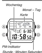
Die Multizeitfunktion des Uhrzeitmodus ermöglicht schnelles und einfaches Abrufen der aktuellen Uhrzeit und des Datums von vier verschiedenen Städten, die von T-1 (Time 1) bis T-4 (Time 4) nummeriert sind. T-1 bezeichnet die Heimatstadtzeit und T-2, T-3 und T-4 sind Ortszeiten. Die Ortszeiten sind mit der Heimatstadtzeit (T-1) synchronisiert.
