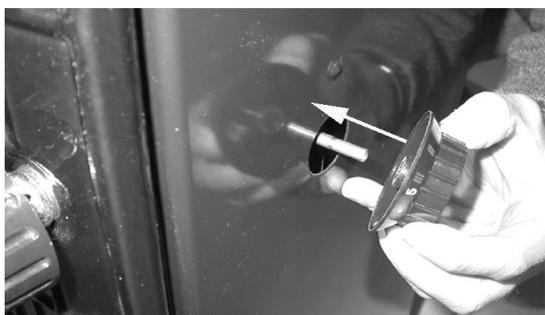
**Abbildung 3:** Montage des Leistungsreglerknopf
